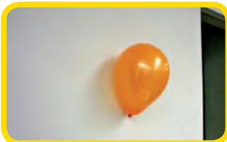
شکل ۱- بادکنک دارای بار الکتریکی به دیوار می‌چسبد.
